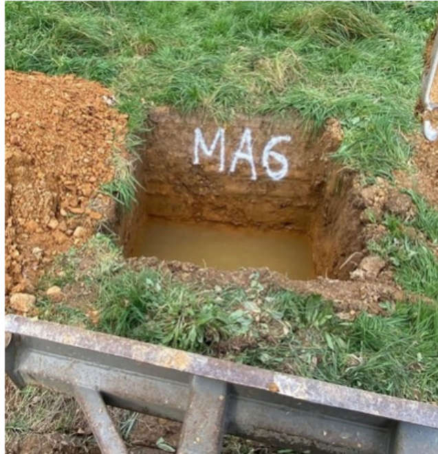
Mesure du temps d'infiltration
