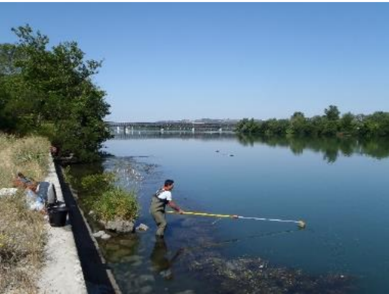
Photo 12 : Prélèvement d'eau à l'aide d'une perche télescopique
