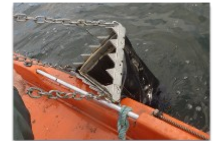
Photo 17 : Prélèvements de macro-invertébrés en cours d'eau profond à l'aide d'une drague
