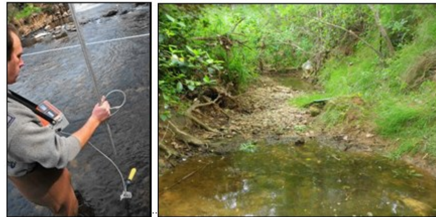
Photo 4 : Mesure du débit à l'aide d'un micro moulinet électromagnétique (Source : ASCONIT Consultants)
