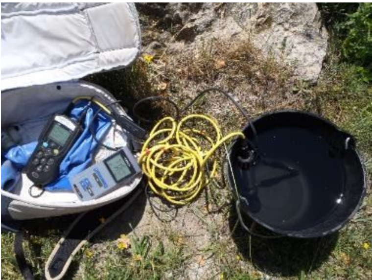
Photo 13 : Sondes multiparamètres utilisées pour mesurer les paramètres in-situ
