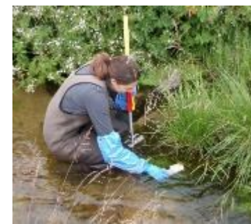
Photo 15 : Prélèvement de macro-invertébrés benthiques en cours d'eau
