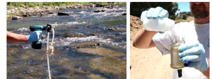
Photo 32 : Exemple d'échantillonnage ADNe par pompage dans le cours d'eau et filtration à l'aide de la capsule dédiée
